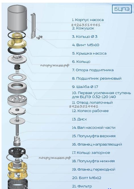
Включает в себя следующие детали: корпус насоса, крышка насоса, втулка, кольцо D 10 KB, опора подшипника, подшипник резиновый, шайба Ø 17, отвод лопаточный KB, колесо рабочее, диск, вал насосной части, полумуфта верхняя, диск KB, кольцо запорное, полумуфта нижняя, фланец переходной, болт М6х12, фильтр, скоба.
